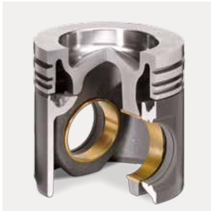
Составной поршень с ковальной стальной верхней частью и алюминиевой юбкой
